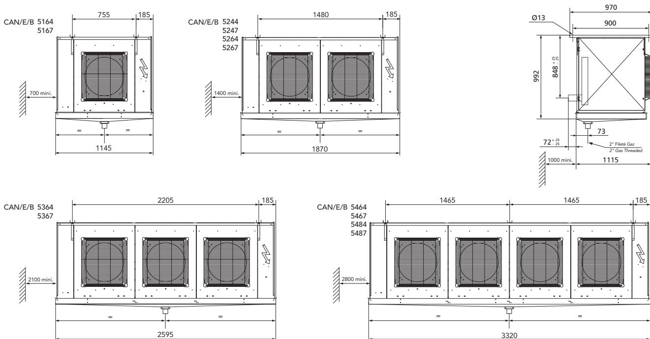
Les dimensions sont données en mm avec une tolérance de  $\pm 10\text{mm}$ .
