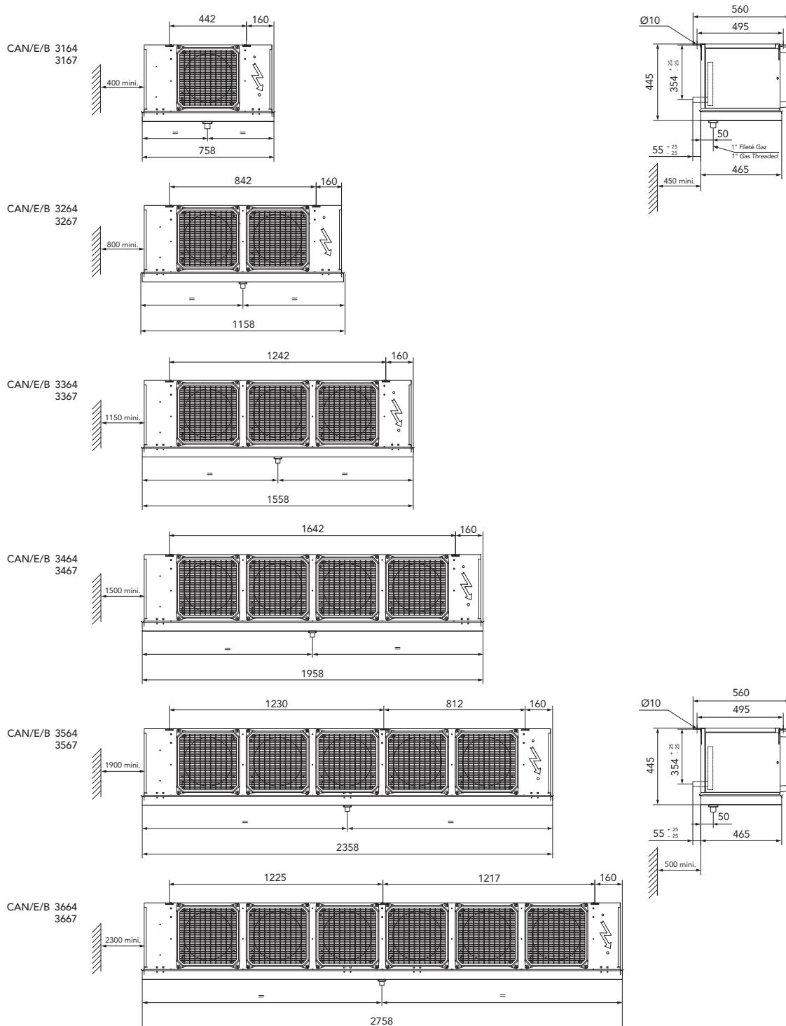
Les dimensions sont données en mm avec une tolérance de  $\pm 10\text{mm}$ .
